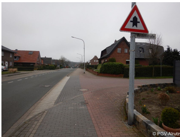
Abb. 5-19: Rad- und Gehwegüberfahrt mit Rampenstein
