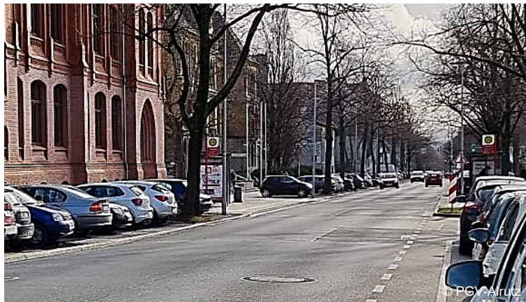
Abb. 5-3: Mischverkehr mit markiertem Sicherheitsraum zum Parkstreifen
