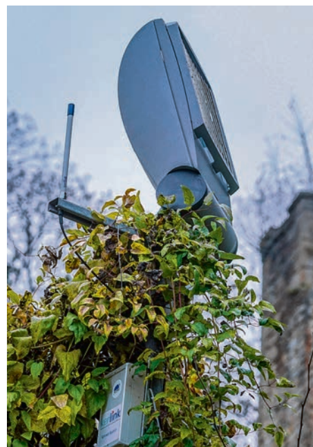
Ein Lorawan-Gateway. Dieser verbindet Endstationen, wie z.B. die Parksensoren mit dem Hauptserver Quelle: Weise;factum
