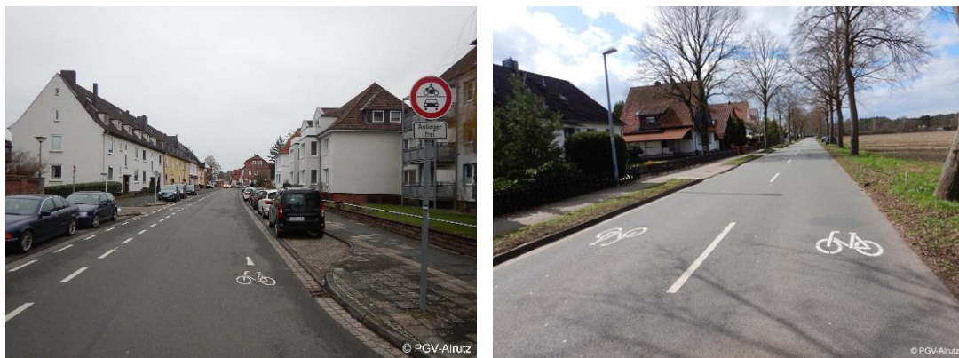
Abb. 5-31: links: Beispiel für gemeinsamen Einsatz eines Schutzstreifens und einer gegenüber liegenden Piktogrammreihe auf der Fahrbahn (Celle); rechts: Beispiel für beidseitige Piktogrammreihen (Poggenhagen)
