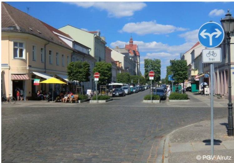
Abb. 5-10: Radverkehr wird durch Zusatzzeichen von dem Fahrtrichtungsgebot für den Fahrverkehr ausgenommen. Hier wird dem geradeausfahrenden Radverkehr auf der gegenüberliegenden Straßenseite die Weiterfahrt entgegen Einbahnrichtung ermöglicht
